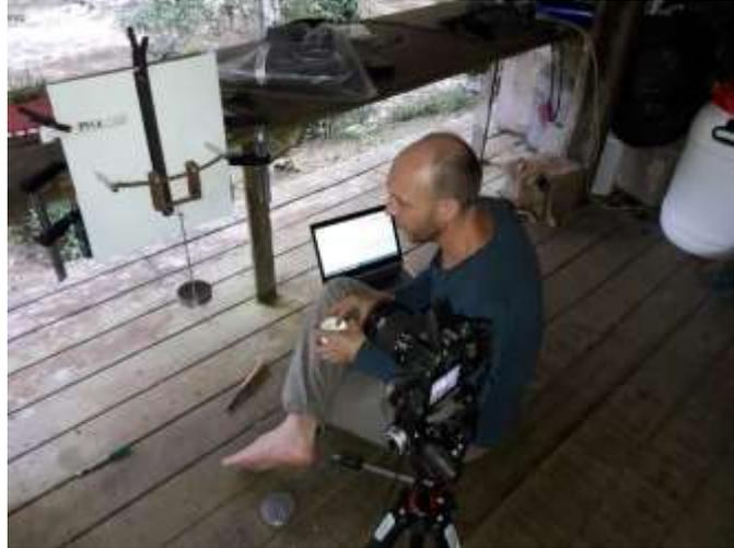
*Figure 19 : Jonathan PRUNIER mesure le module d'élasticité d'une branche. Entre chaque chargement, une photo de la branche est prise et la déformation est ensuite mesurée par analyse d'image (@ Bruno Clair)*
