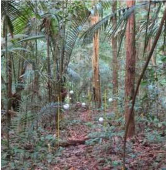
*Figure 21 : Les boules de Noël visible sur cette photo représentent les cibles permettant de concaténer les scans à l'analyse (@ E-Ping Rau)*
