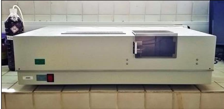
Figure 9 : Analyseur AMA 254 utilisé pour mesurer la concentration de mercure dans la chair des poissons
