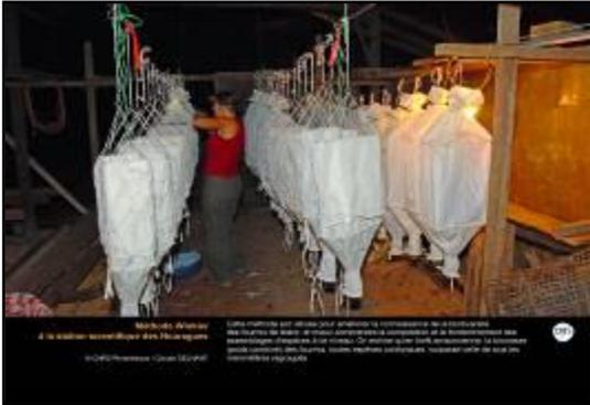
Dans ces drôles d'entonnoirs se trouvent des carottes (échantillons) de sol. La faune de litière et de la première partie du sol ont besoin d'humidité et d'obscurité. La lumière placée au dessus des entonnoirs et la déshydratation progressive du haut vers le bas, pousseront la faune du sol à chercher refuge jusqu'au fond de l'entonnoir où ils tomberont alors dans un gobelet rempli d'alcool.
