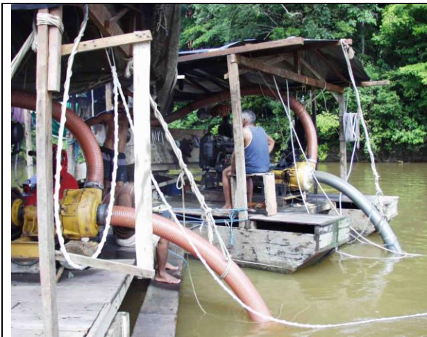
Deux barges accolées, pompant le fond de l'Approuague (décembre 2003). Remarquer les gros tuyaux d'aspiration des sédiments et les petits tuyaux approvisionnant les plongeurs en air.
