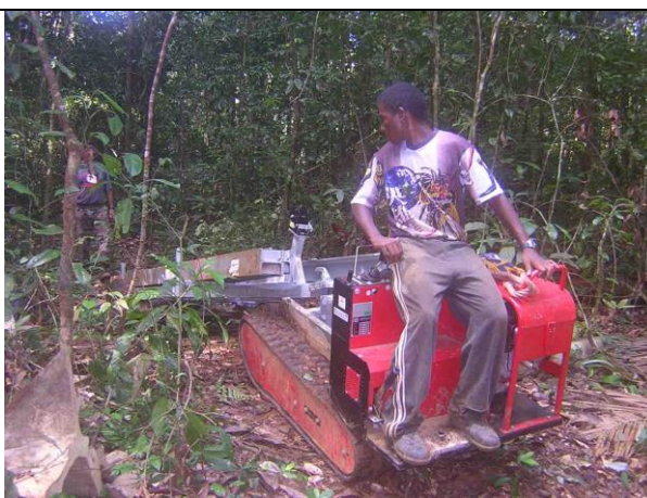
Transport de poutrelles à l'aide du mini tracteur à chenille (Mitch)
