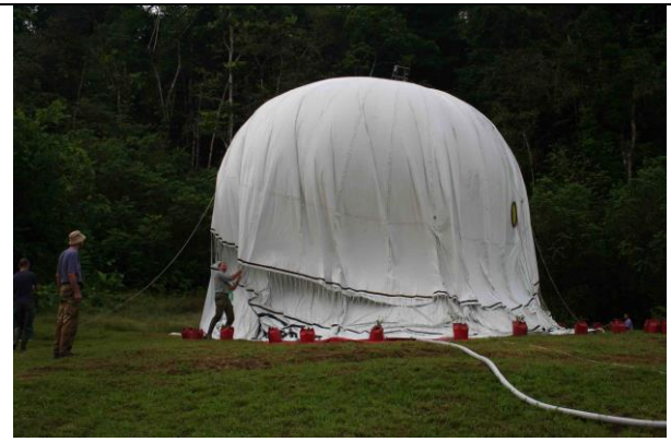
Gonflage du ballon. Au fur et à mesure, les sacs de lest sont ajoutés, puis déplacés à des niveaux inférieurs (18/5/2006).
