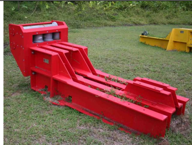
Nouvelles têtes de pylônes en attente de leur installation pour le nouveau dispositif COPAS « light » (16/10/2010).
