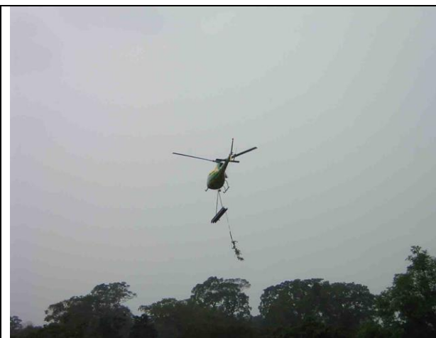
Piste de Bélizon, transport de poutrelles. L'arbuste attaché à la charge sert de dérive.
