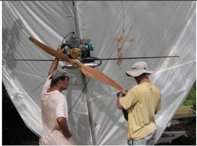
La propulsion du dirigeable était assurée par un moteur de tondeuse à gazon équipé d'une hélice. De gauche à droite, 'Papillon' et Thierry Garçon.
