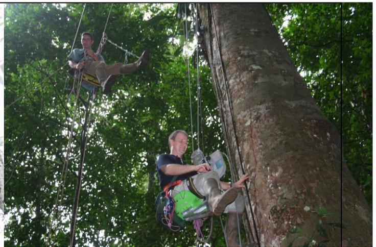
Les tentatives de mise au point et d'amélioration du matériel de grimper sont toujours en cours. A droite, essais par Philippe Gaucher d'un siège manipulable par manivelle et câble, à gauche sellette descendant le long d'une corde 'spéléo'. Montagne de Kaw, 2006.
